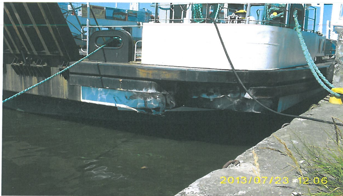
Zdjęcie 2. Uszkodzenie kadłuba – widok ogólny
