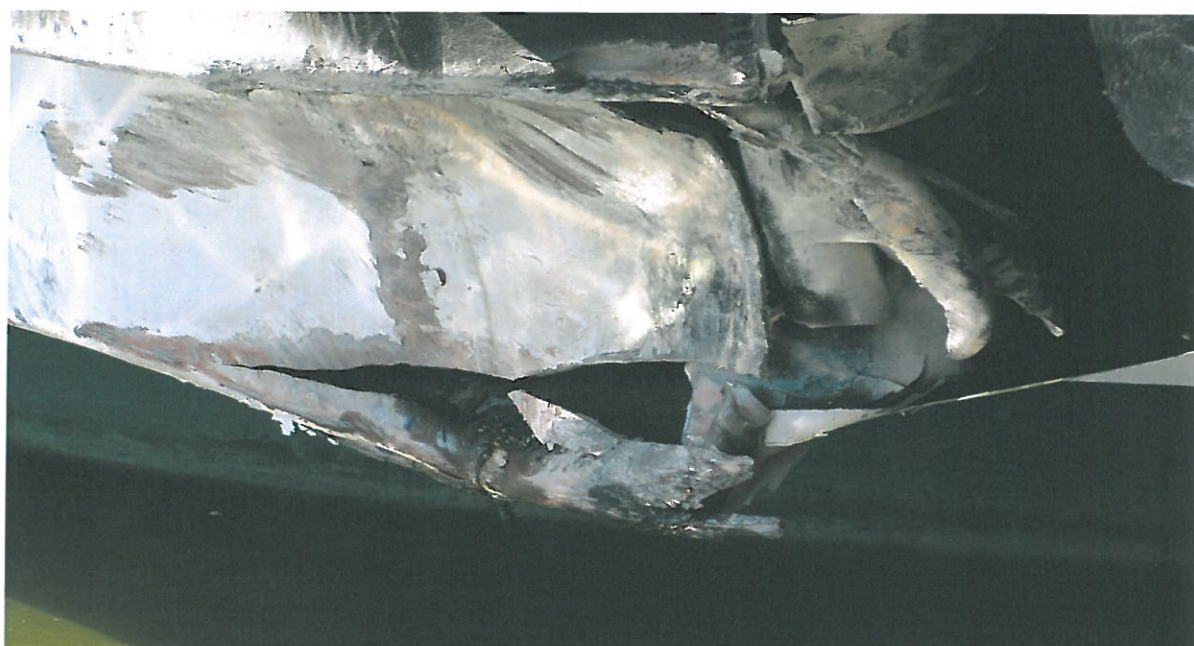
Zdjęcie 5. Uszkodzona pawęż rufowa
