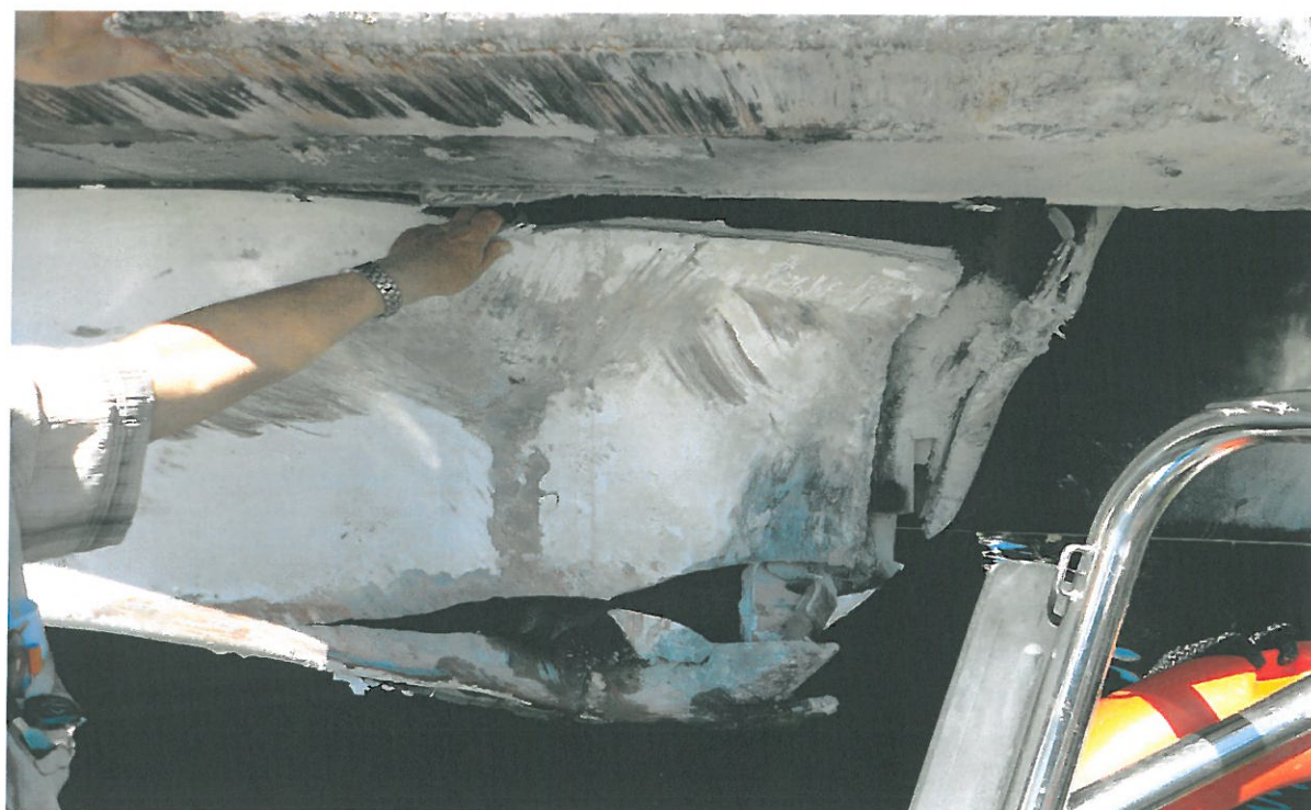
Zdjęcie 3. Rozdarta blacha czołowa pawęży rufowej
