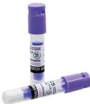
Obraz 4 Testy ampułkowe do kontroli biologicznej sterylizacji w autoklawie parowym
