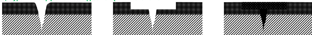
Rys. 5.12.1.1. Schemat wypełniania spękań metodą pasmową
