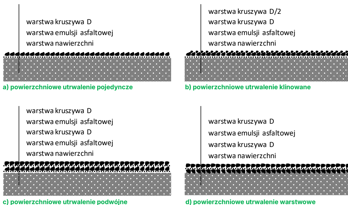
Rys. 5.6.2. Przykład wykonania powierzchniowego utrwalenia w zależności od przeznaczenia, stanu podłoża i kolejności układania poszczególnych warstw
