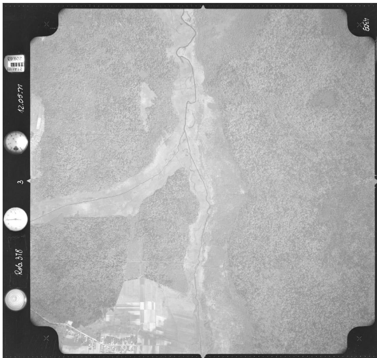
Rysunek II.12 Świeżo uregulowane (wyprostowane) koryto rz. Narewki i Łutowni na terenie Nadleśnictwa Białowieża oraz Białowieskiego Parku Narodowego z widocznymi, odciętymi meandrami. Zdjęcie wykonano 12.05.1971 r. Źródło danych: CODGIK.
