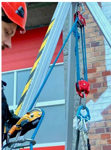
Zdjęcie 8. Układ do opuszczania 4:1. Opuszczanie z przyrządu
