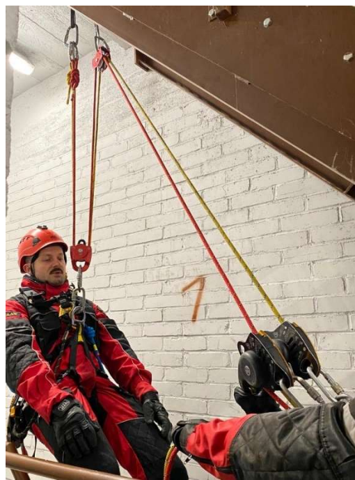
Zdjęcie 6. Układ do opuszczania 2:1 (bliźniaczy) ze zmianą kierunku
