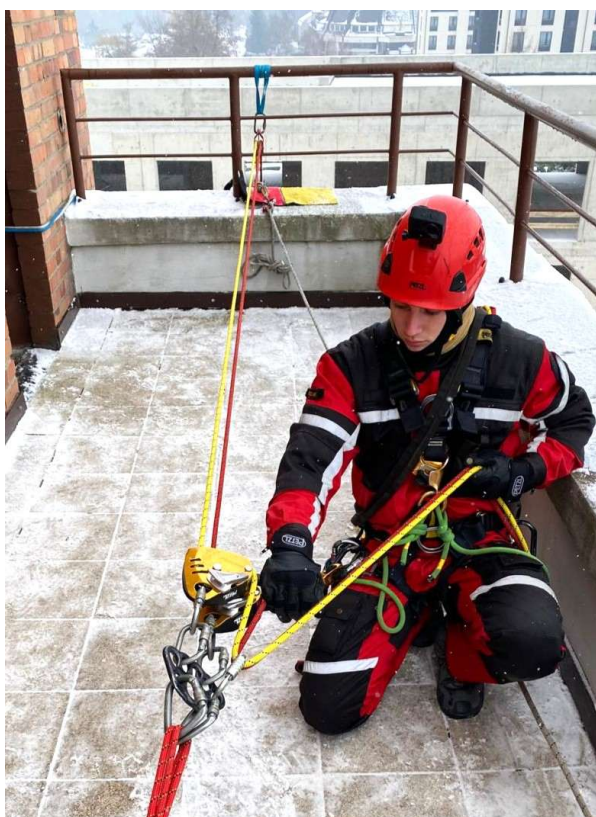
Zdjęcie 1. Układ do opuszczania 1:1 (bliźniaczy) ze zmianą kierunku nad krawędzią
