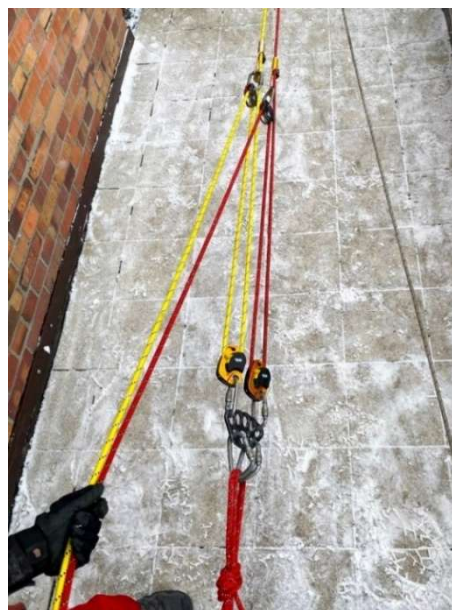
Zdjęcie 18. Układ do podnoszenia 3:1, bloker – Petzl Pro Traxion
