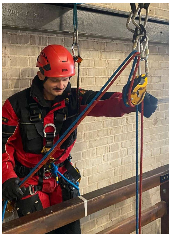
Zdjęcie 2. Układ do opuszczania 1:1 (bliźniaczy)
