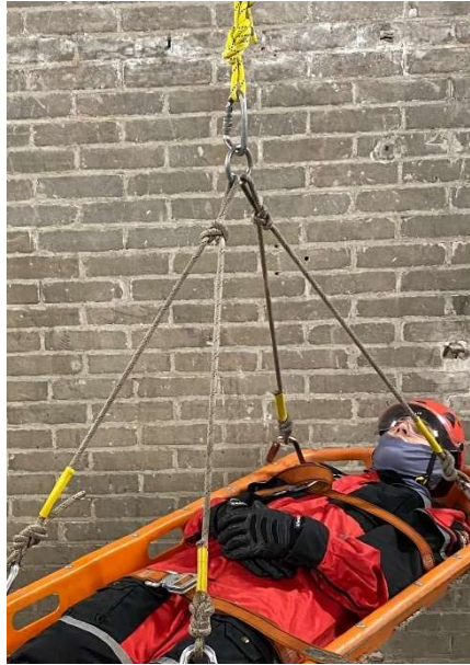
Zdjęcie 28. Dopięcie noszy w układzie wyciągowym balans, punkt centralny – ring stalowy
