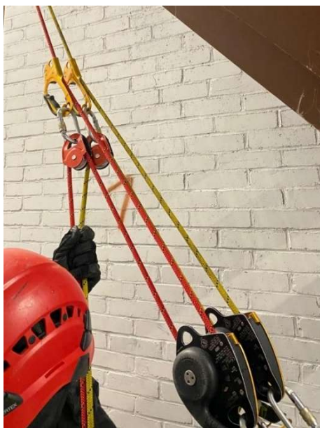
Zdjęcie 17. Układ do podnoszenia 3:1, bloker – Petzl Maestro
