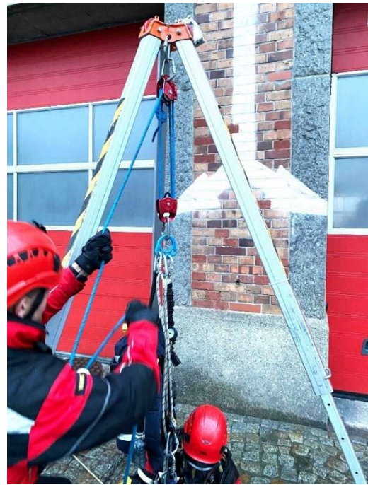
Zdjęcie 20. Układ wyciągowy 4:1 na trójnogu, praca rąk
