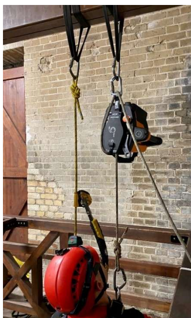
Zdjęcie 43. Wyciągarka ActSave ACX zawieszona do konstrukcji stalowej. Autoasekuracja ratownika na dodatkowej linii asekuracyjnej
