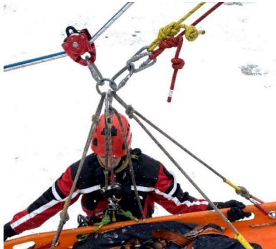
Zdjęcie 27. Dopięcie noszy w układzie do opuszczania z liną kierunkową, punkt centralny – ring stalowy
