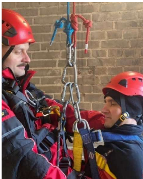
Zdjęcie 29. Dopięcie trójkąta ewakuacyjnego w układzie do wyciągania 3:1, punkt centralny – karabinek
