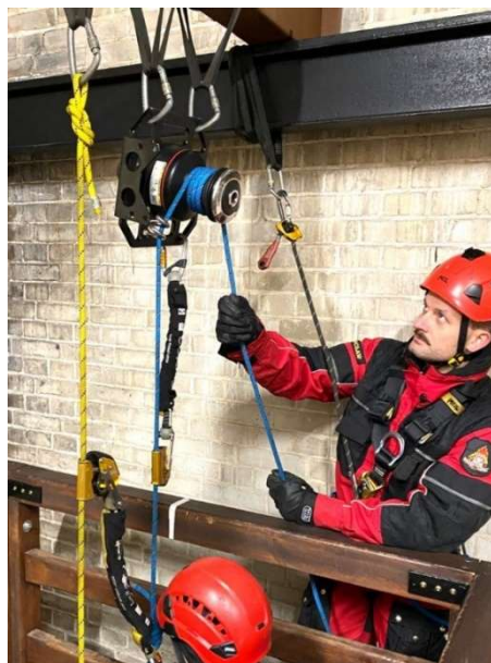
Zdjęcie 40. Wyciągarka Harken zamontowana na konstrukcji
