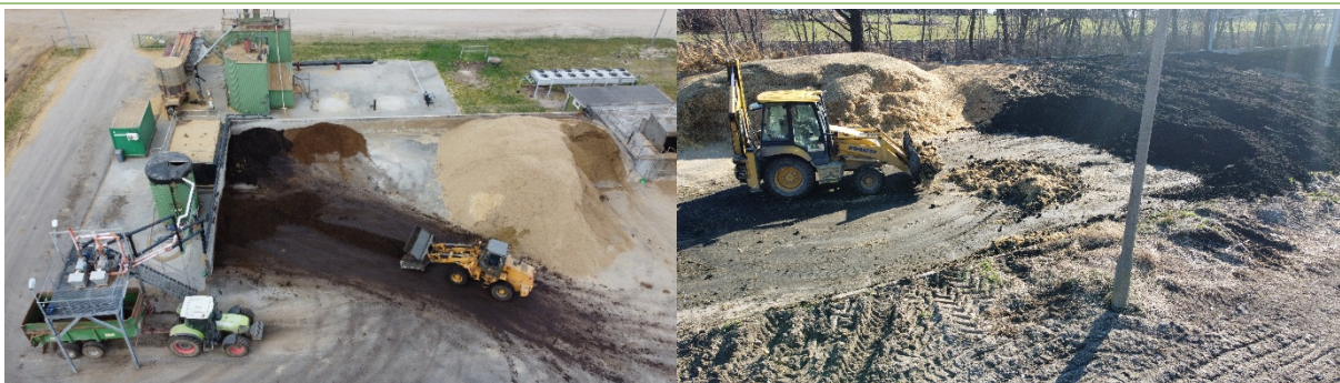
Ryc. 2. Mieszanie pofermentu z torfem (po lewej) i osadu ściekowego ze słomą (po prawej) przy użyciu ciężkiego sprzętu.
