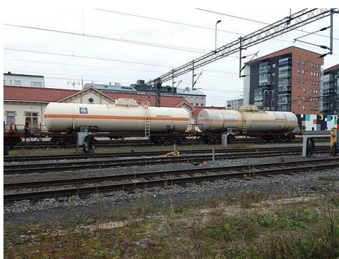
Rys. 50. Cysterny kolejowe do transportu ciekłego NH 3 , Finlandia [65].
