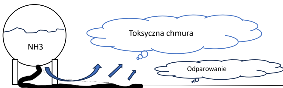
Rys. 59. Następstwa rozszczelnienia zbiornika ciekłego amoniaku [66].
