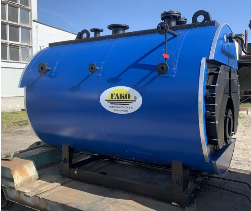
Rys. 25. Zdjęcie poglądowe kotła parowego RPW bez osprzętu [46].
