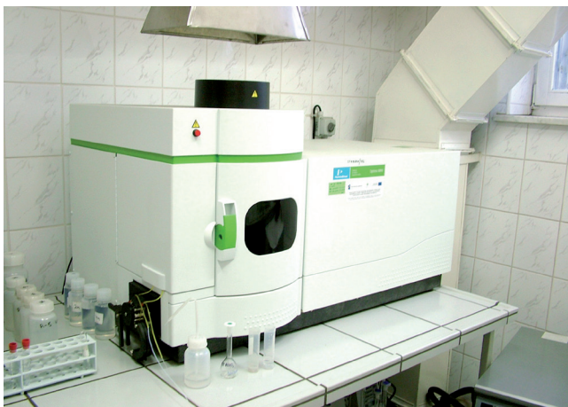
Fot. 1. Spektrometr ICP-OES w Pracowni Analiz w Częstochowie
