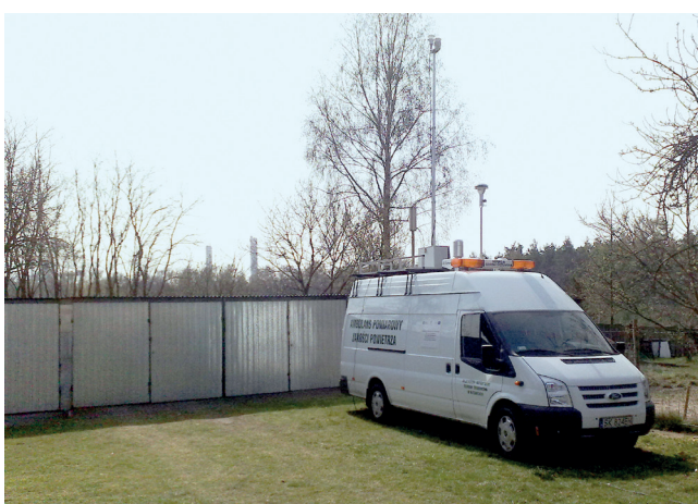
Fot. 2. Ambulans pomiarowy imisji zanieczyszczeń powietrza
