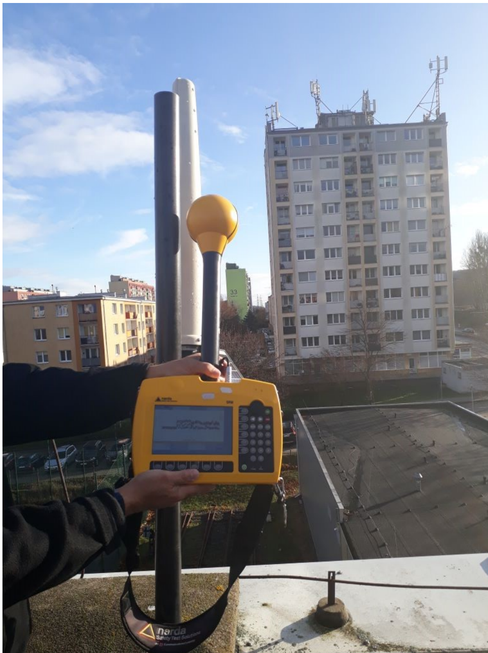
Rys. 8 ZSET w Gdyni – pomiary selektywne SRM-3600
