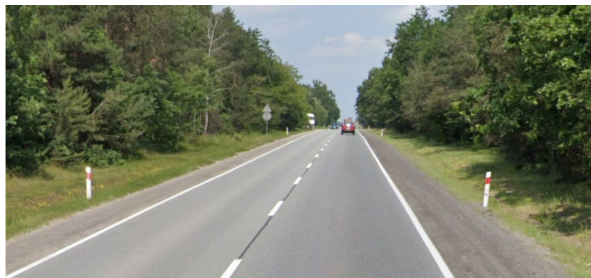
Droga krajowa jednojezdniowa pobocza nieutwardzone. Zastosowanie linii krawędziowych P-7c i P-7d(wąskich 12cm)
