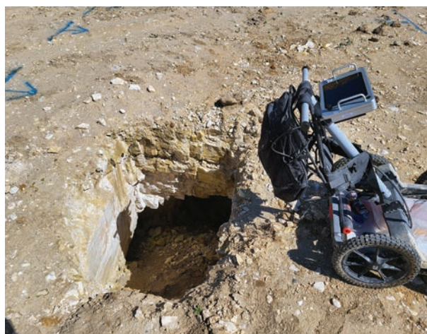
► Rys. 2. Pustka skalna w stropie I poziomu złoża Działoszyn-Trębaczew ► Fig. 2. Rock void in the ceiling of the first level of the Działoszyn-Trębaczew deposit
