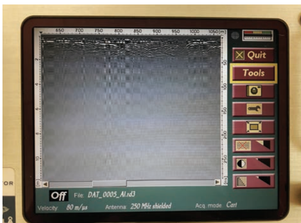
► Rys. 8. Przykładowy echogram 2D. Profilowanie wykonane w przodku XIII w ramach rozpoznania obszaru perspektywicznego
