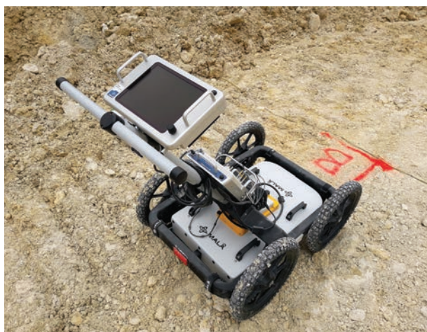
► Rys. 1. Georadar ProEx firmy Mała z anteną 250 MHz ► Fig. 1. Mała ProEx GPR with a 250 MHz antenna
