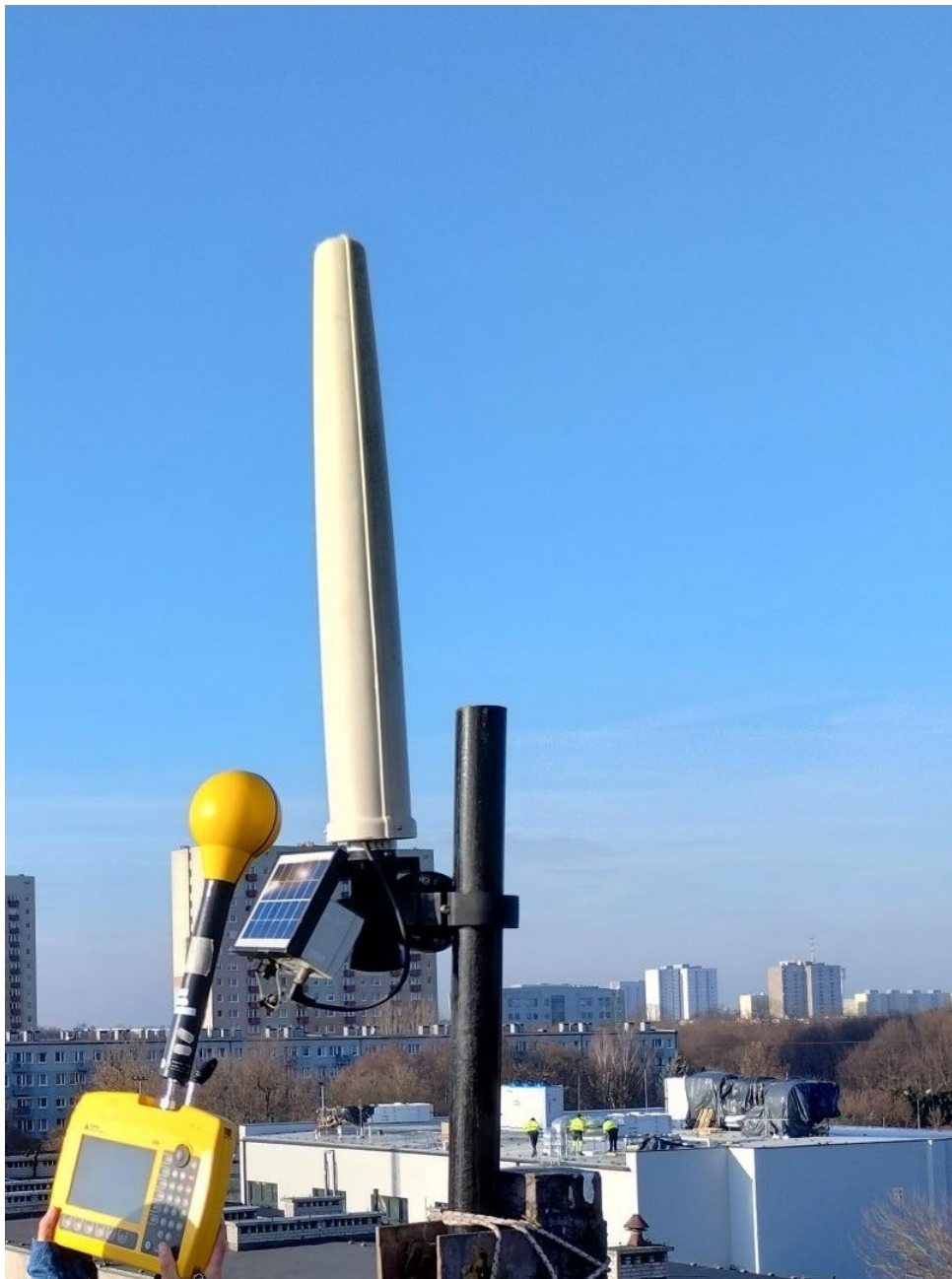
Rys. 7 Wichrowe Wzgórze 10 – pomiary selektywne SRM-3600
