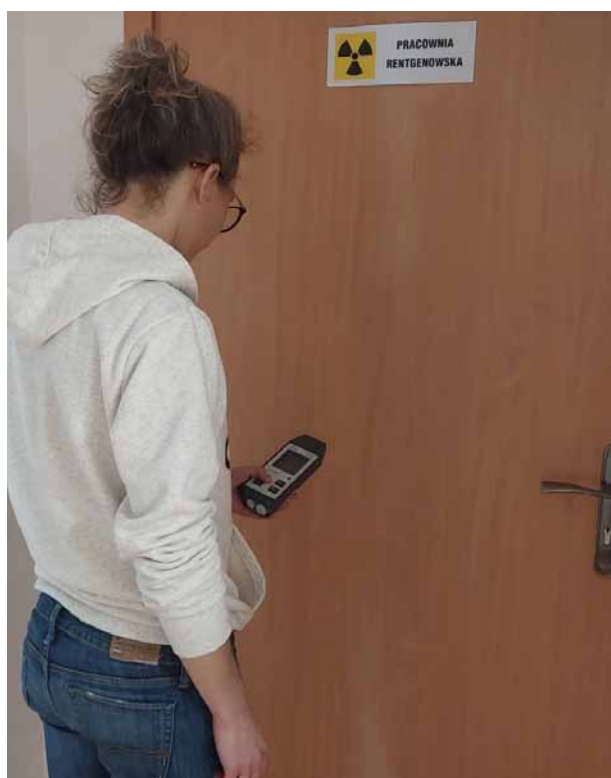
Rysunek 4. Pomiar rozkładu mocy dawki za osłonami stałymi
