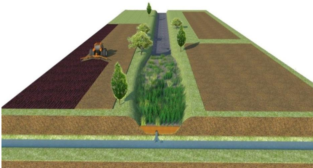
Ryc. 83. Przykład oczyszczania spływów rolniczych z udziałem układów przyrodniczych (źródło: Mioduszeński i Okruszko 2016 za: LIMNOS, Company for Applied Ecology, 2015)
