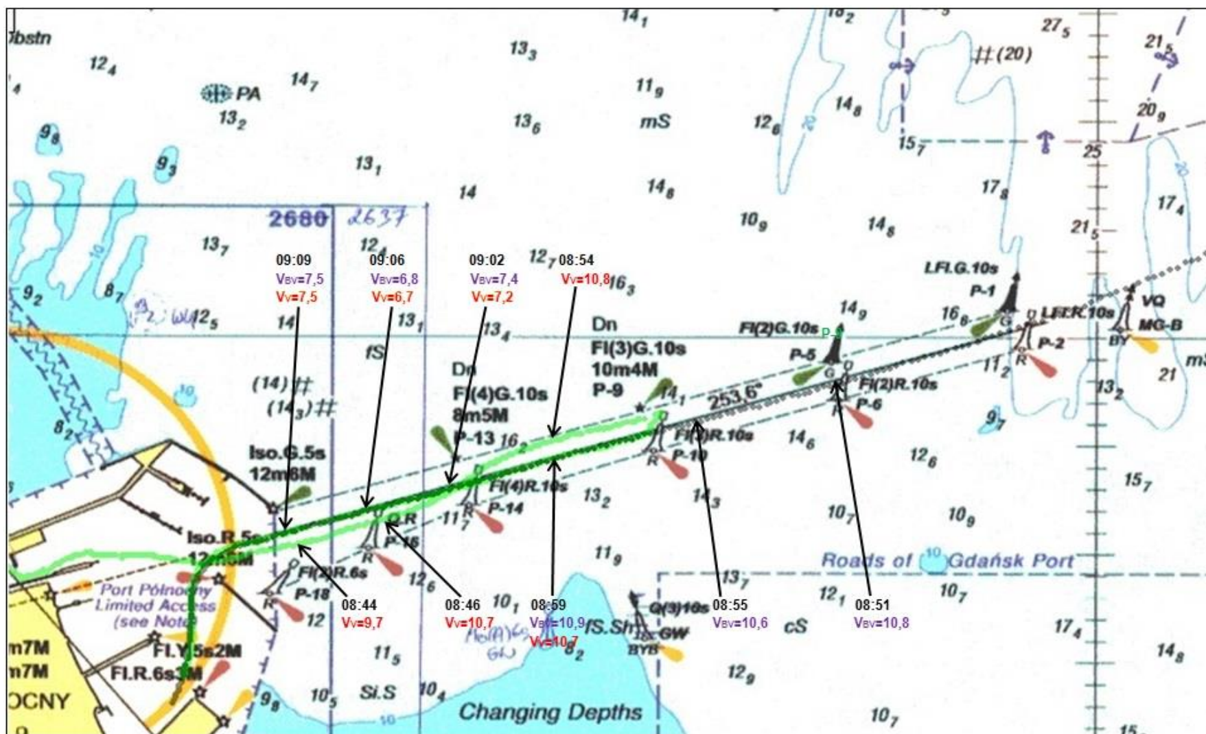
Rysunek 1. Zapis trajektorii ruchu statku oraz holownika ze znacznikami czasu i prędkości
