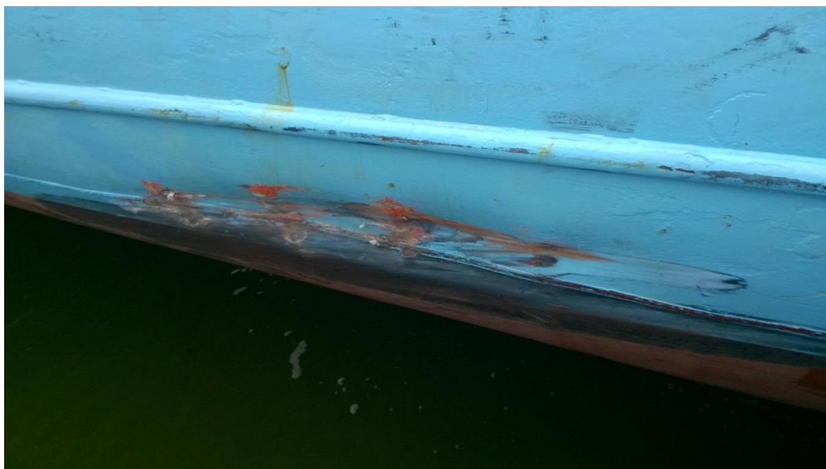
Zdjęcie nr 3. Wgniecenie poszycia „Bomar Victory” w miejscu kontaktu z „Virtusem”
