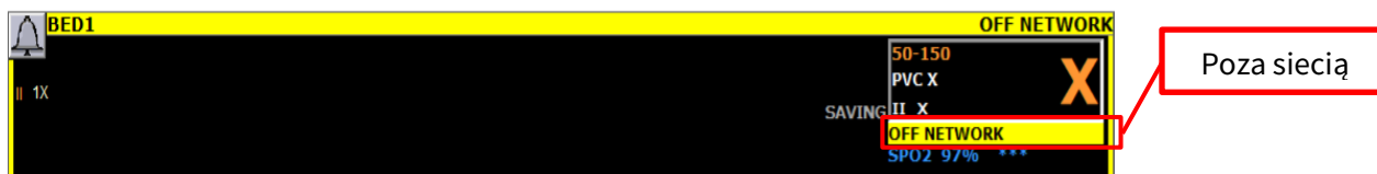
Rysunek 2. Przykład stanu Poza siecią w oknie Multi-Viewer stacji centralnej z dźwiękowymi i wizualnymi wskaźnikami alarmowymi (ikona dzwonka i migający pasek tytułu)
