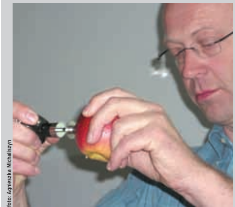
Pomiar twardości jabłka demonstrowany przez Gerharda Petersa, niemieckiego eksperta w klasyfikacji owoców i warzyw
