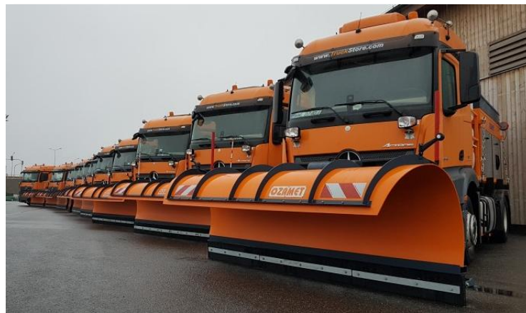
Fot. 3 Pojazdy przeznaczone do zimowego utrzymania dróg w Obwodzie Drogowym uzbrojone w pługi odśnieżne i posypywarki wraz ze zbiornikami na solankę.
