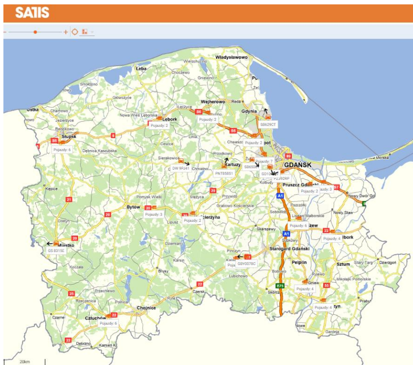
Fot. 5 Podgląd z programu do monitorowania pracy sprzętu z wykorzystaniem lokalizatorów GPS.
