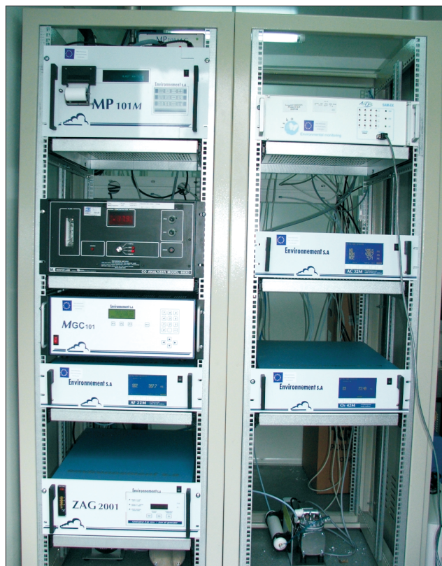
Fot. 2. Wyposażenie automatycznej stacji monitoringu powietrza
