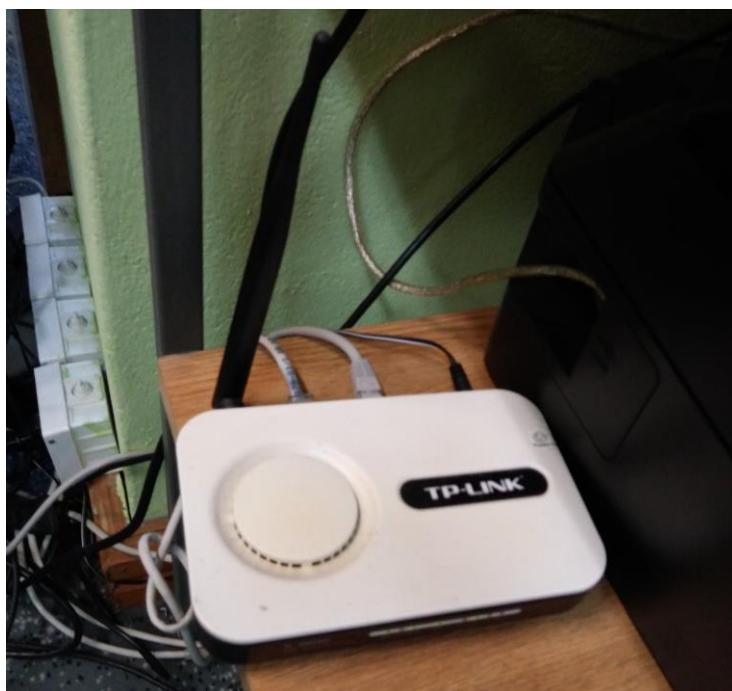
Fot. 2: Zdjęcie punktu dostępowego model TL-WR340G
