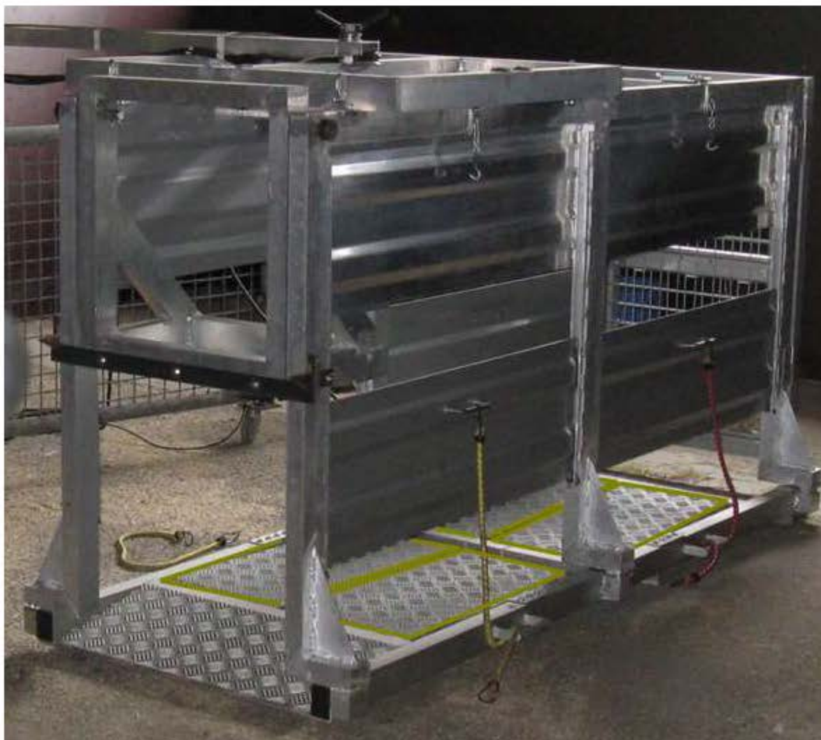
Rysunek 80. Waga SowSIS do ważenia 4 kończyn niezależnie. Diagnostyka kulawizny zwierząt
