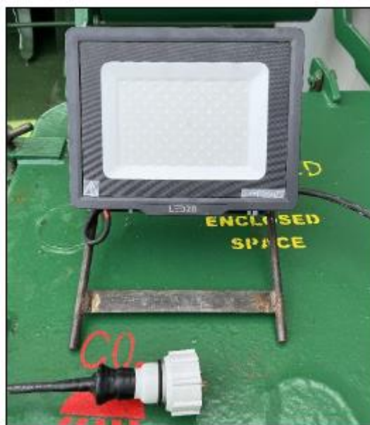
Rysunek 3: Przenośny reflektor ładowni używany na pokładzie
