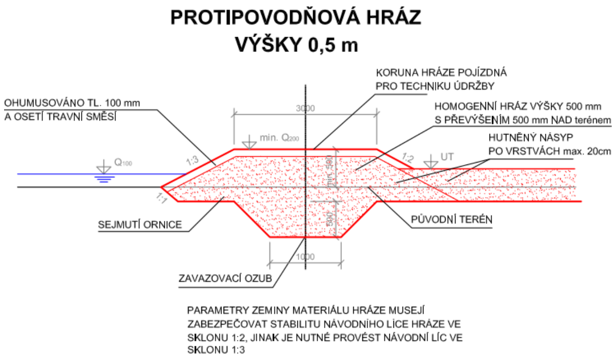
Rysunek 4: Przekroje typowe wału przeciwpowodziowego
