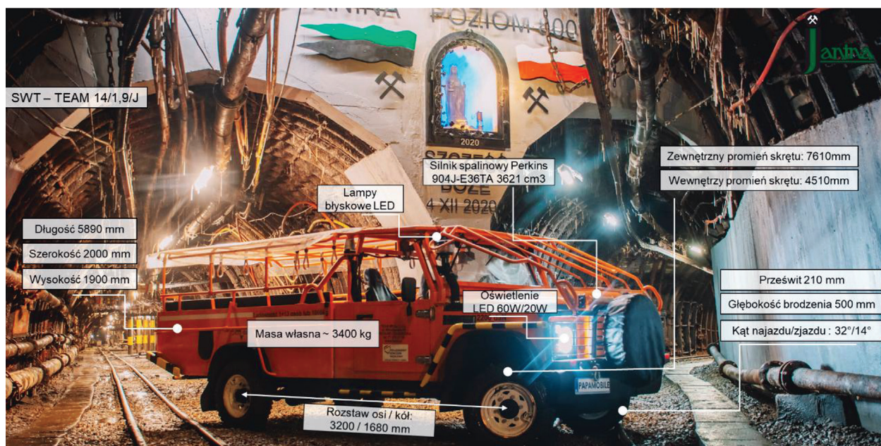
► Rys. 6. Parametry samojezdnego wozu transportowego SWT-Team 14/1,9/J
