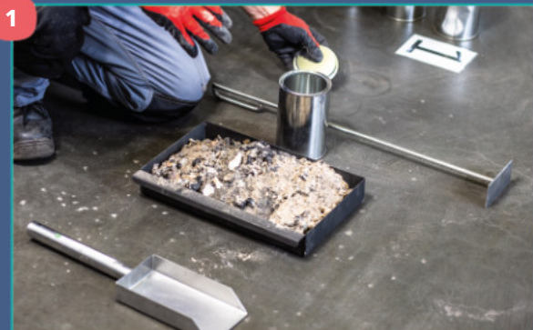
1 Przygotowanie do pobierania. Widok wyciągniętej z popielnika kotła c.o. szuflady wypełnionej po brzegi (z dużą ilością popiołu) odpadem paleniskowym i narzędzi niezbędnymi do pobierania próbki
