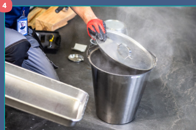
Ograniczenie pylenia po przesypianiu odpadu paleniskowego z tacy do wiadra. Zabieg zamknięcia wiadra pokrywą umożliwia zminimalizowanie utraty masy odpadu paleniskowego poprzez pylenie, a także odcina dopływ tlenu do popiołu i w razie potrzeby umożliwia jego bezpieczne odstawienie
