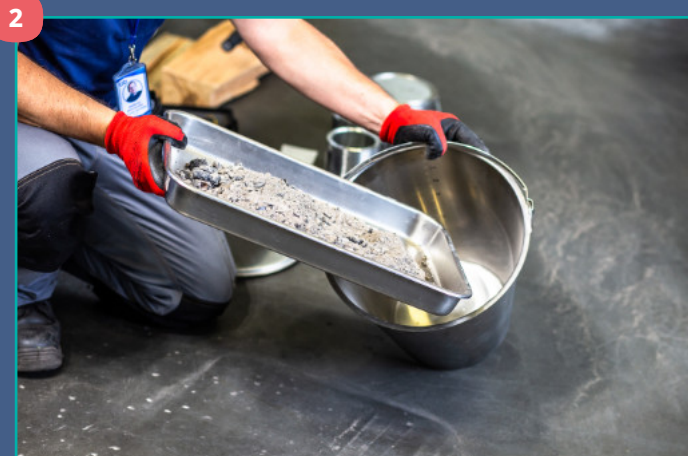
Przygotowanie do przesypywania odpadu paleniskowego z tacy do wiadra
