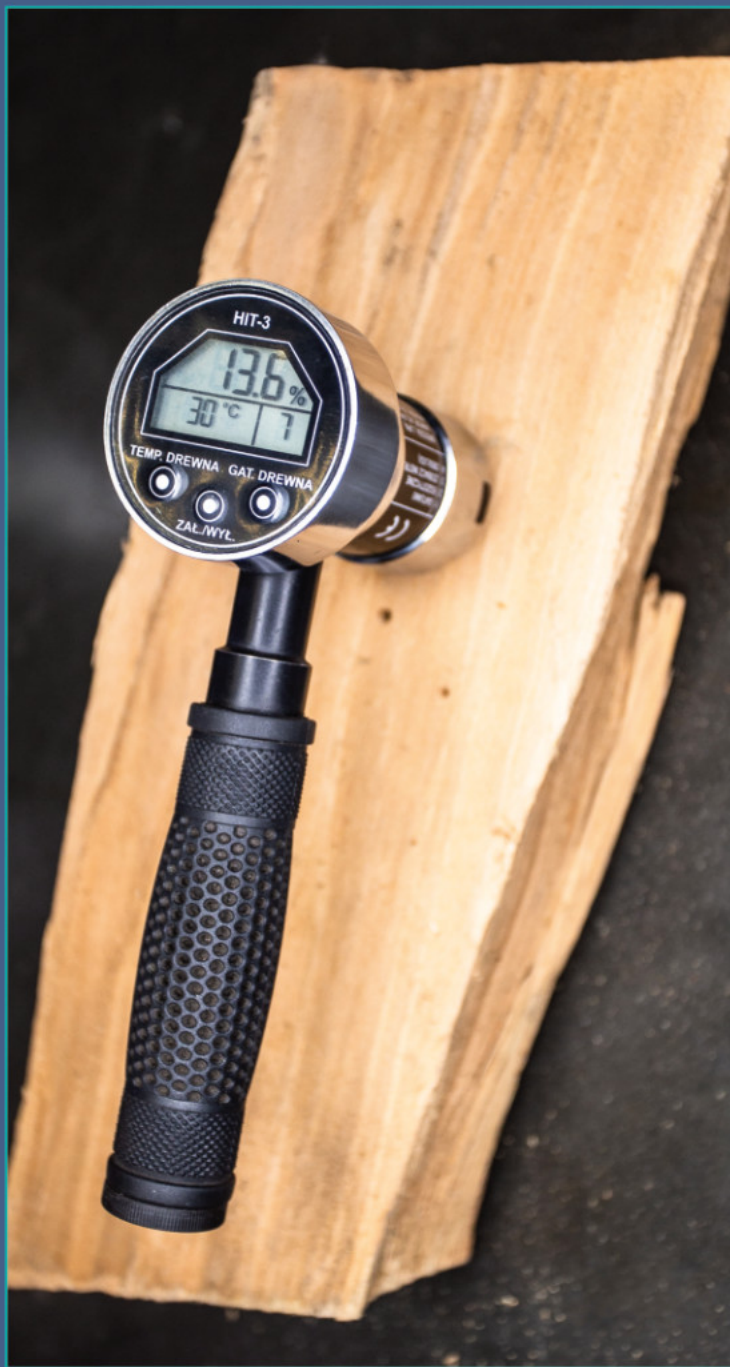
Widok wilgotnościomierza wbitego w polano drewna, z wyświetlanym wynikiem pomiaru i ustawieniami
