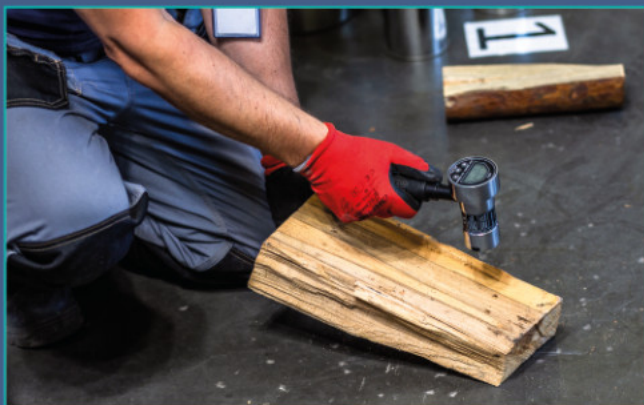
Ustawienie polana do precyzyjnego wbicia elektrod wilgotnościomierza rezystancyjnego, z ustawionymi parametrami dedykowanymi dla wykonywanego pomiaru (temperatura i gatunek drewna)
