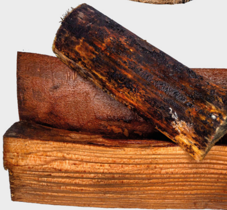
Zdj. 42. Mokre drewno (wilgotność powyżej 20%)
