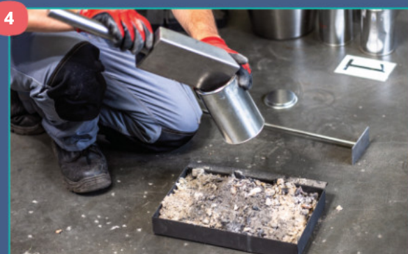
4 Przenoszenie porcjami górnej warstwy odpadu paleniskowego do pojemnika, w którym próbka zostanie przekazana do laboratorium akredytowanego. Pojemnik laboratoryjny – puszka, w trakcie przesypywania popiołu powinna się znajdować nad pojemnikiem, z którego pobiera się próbkę
