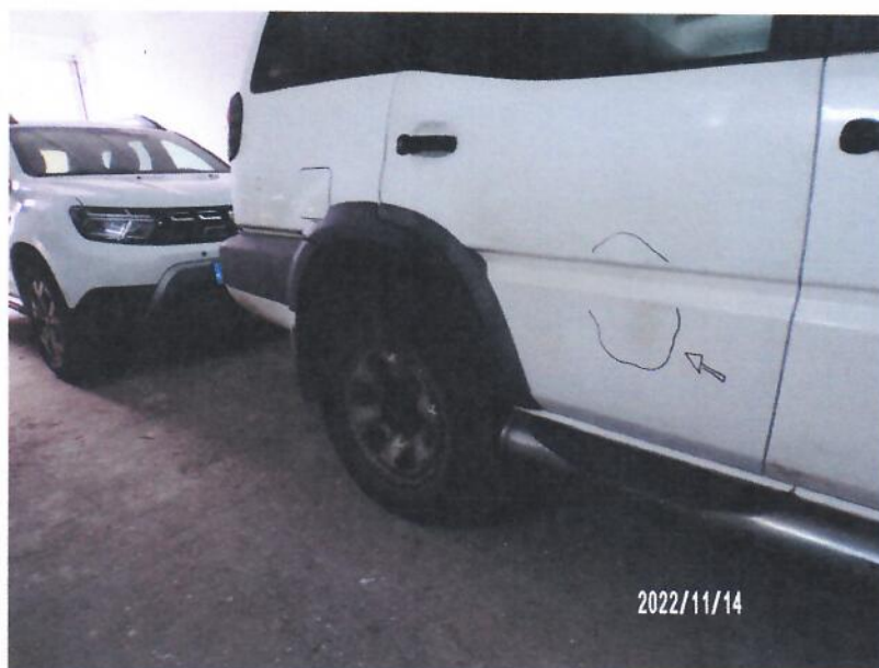
Wgniezione poszycie drzwi tylnych oraz punktowe wgniecenia błotnika tylnego
