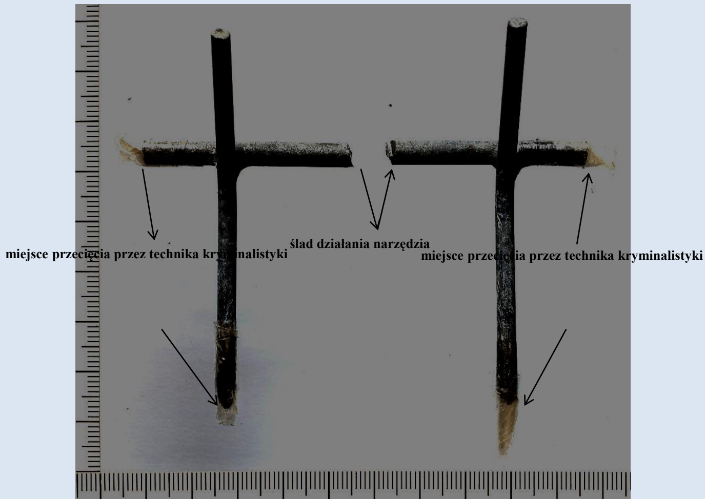
Fot. 20. Prawidłowo zabezpieczony do badań mechanoskopijnych z fragmentów drutu z wyników /M. Dąbrowski.
