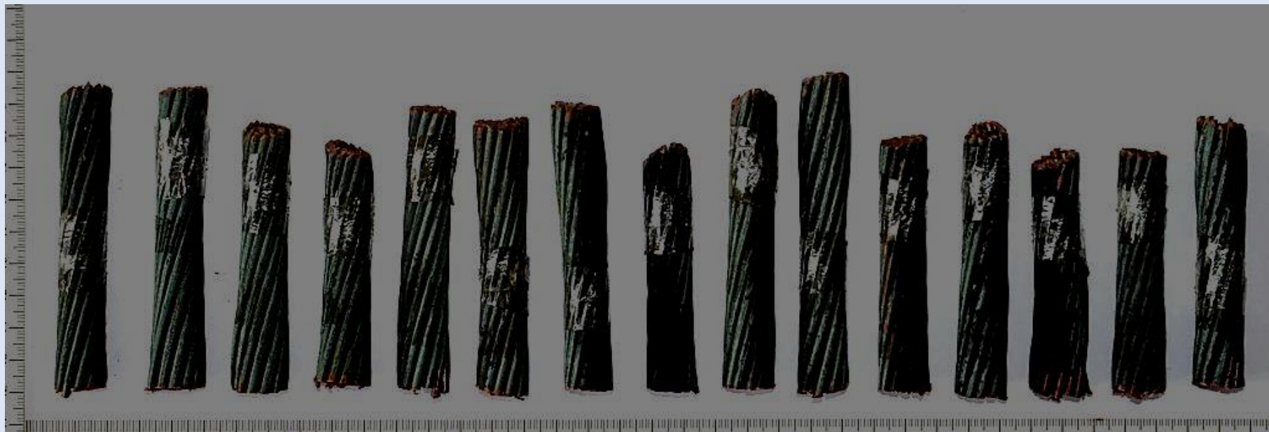
Fot. 21. Nieprawidłowo zabezpieczone do badań mechanoskopijnych fragmenty linek z wnyków /M. Dąbrowski.
