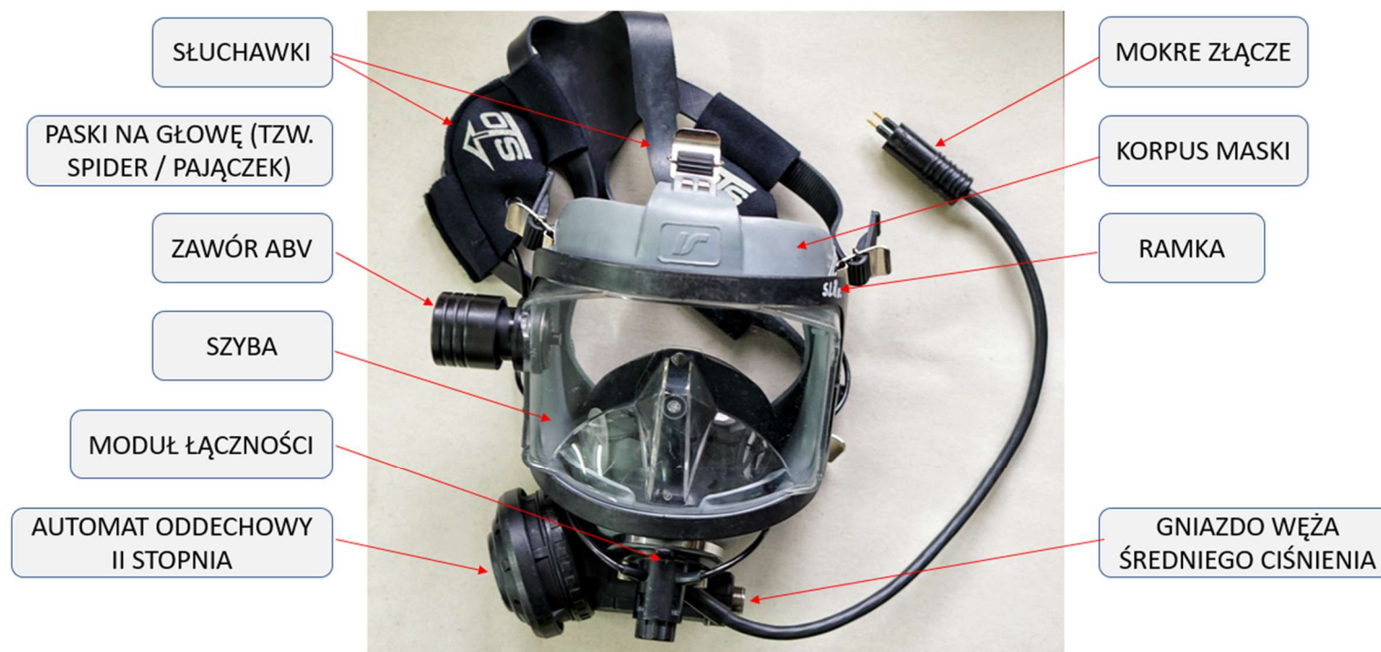
rys. 64 Maska pełnotwarzowa AGA MK II (widok od przodu)
