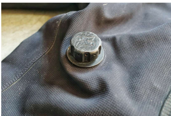
rys. 71 Zawór ulgi tzw. P-valve
