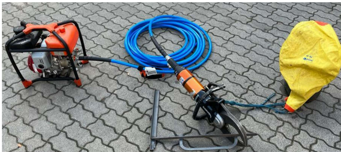
rys. 102 Zestaw przygotowany do pracy pod wodą
