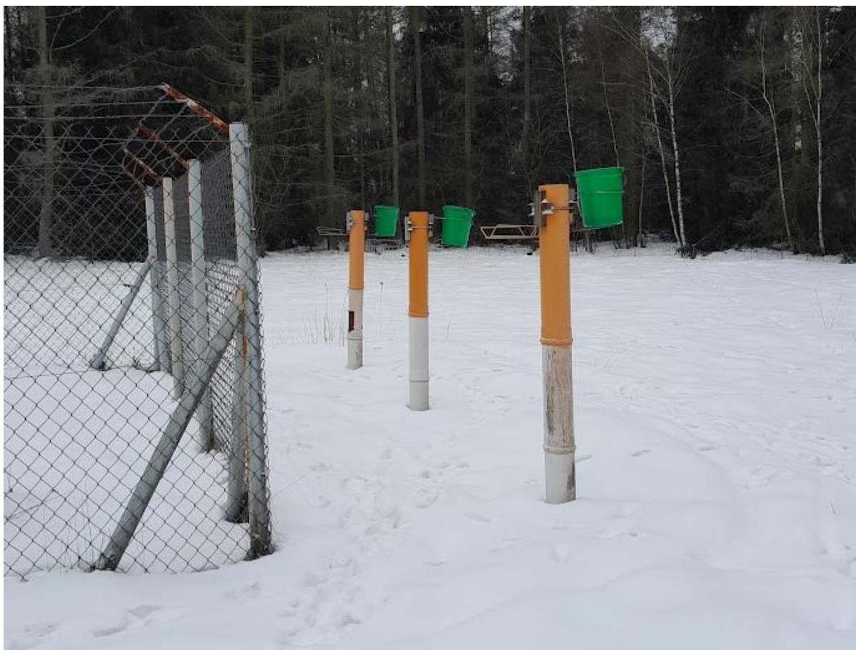
Fot. 2.2. Kolektory na otwartej przestrzeni do pomiaru w okresie zimowym depozytu mokrego zainstalowane na powierzchni monitoringu intensywnego nr 326 (53/6) w Nadleśnictwie Łąck
