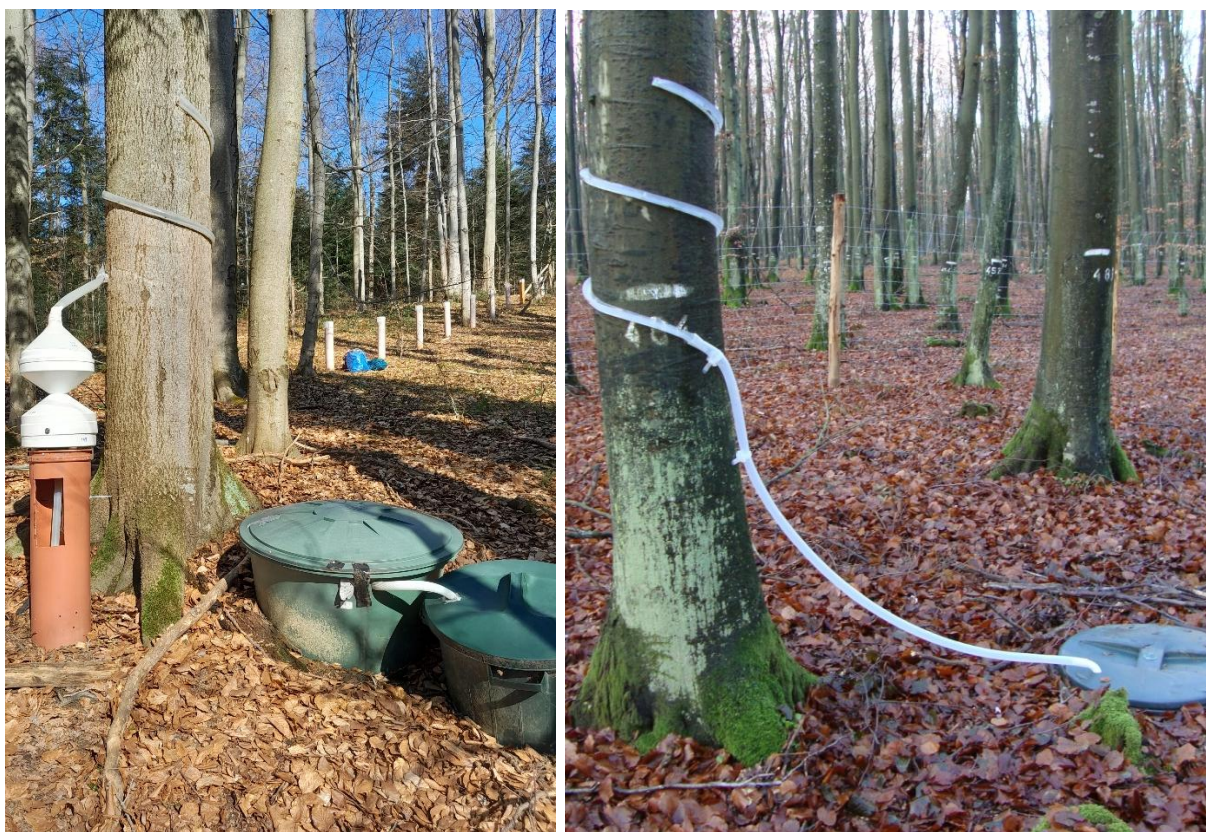
Fot. 2.4. Instalacje do pomiaru spływu po pniu na SPO MI nr 804 i 116 (108/4 i 71/15) w Nadleśnictwach Bircza i Gdańsk (drzewostany bukowe)
