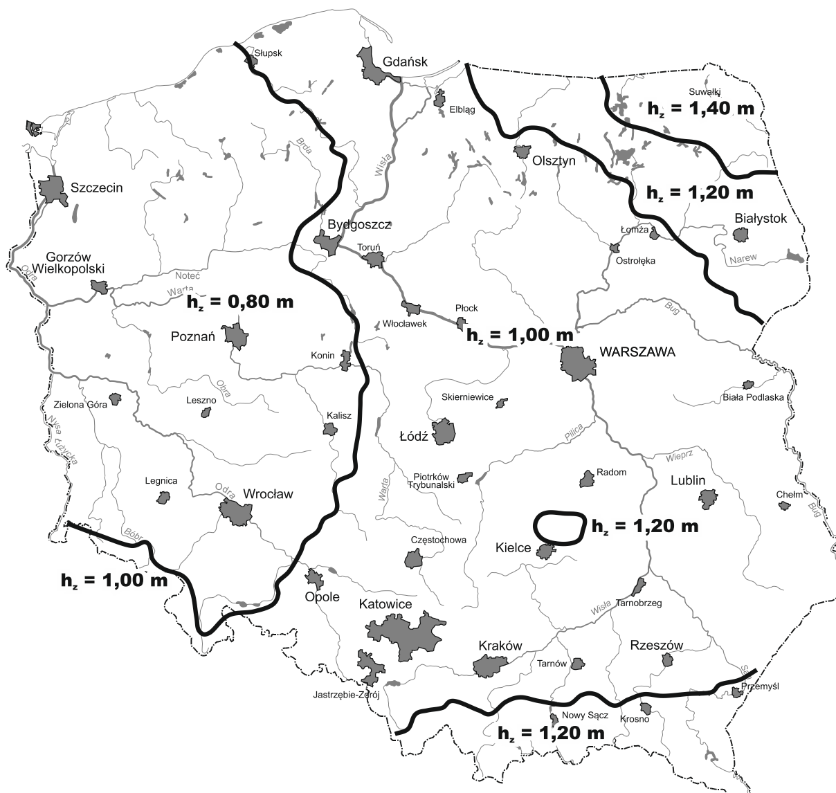
Rys.10.1.1. Głębokość przemarzania gruntu h_z według normy [2]
