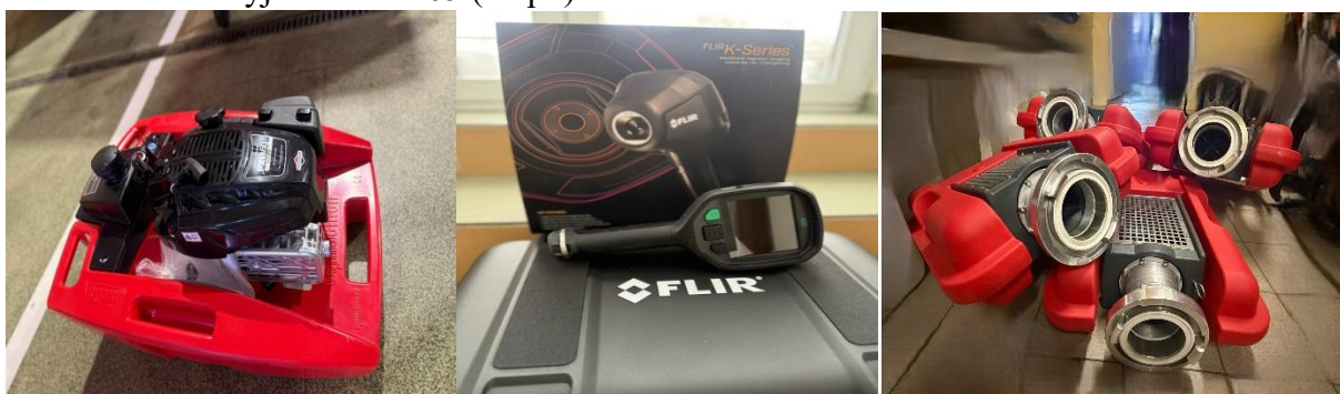
Rysunek 22. – Motopompa Niagara 3, Kamera Termowizyjna FLIR K65, pływające smoki ssawne.
