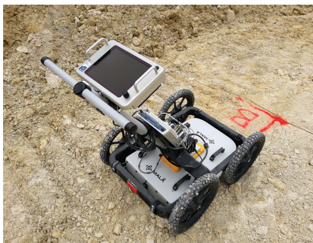
► Rys. 1. Georadar ProEx firmy Mała z anteną 250 MHz ► Fig. 1. Mala ProEx GPR with a 250 MHz antenna
