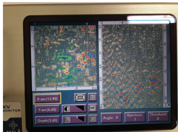
► Rys. 11. Wynik obróbki danych w postaci echogramu 3D w programie 3D Grid Project
