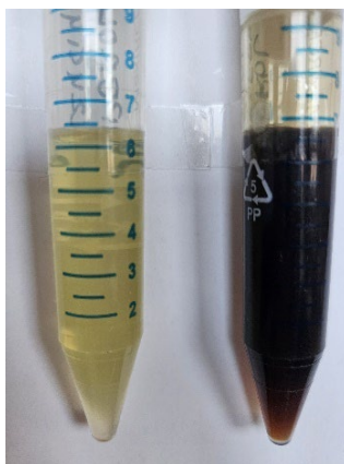
Rycina 1. Wygląd próbek tego samego oleju nowego (po lewej) i przepracowanego w silniku spalinowym.
