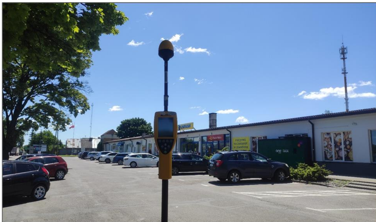
Pomiar PEM (pomiary szerokopasmowe) przy użyciu miernika NBM – 550 NARDA (monitoring badawczy pkt. w m. Białopole) Fot. Łukasz Chudzik
