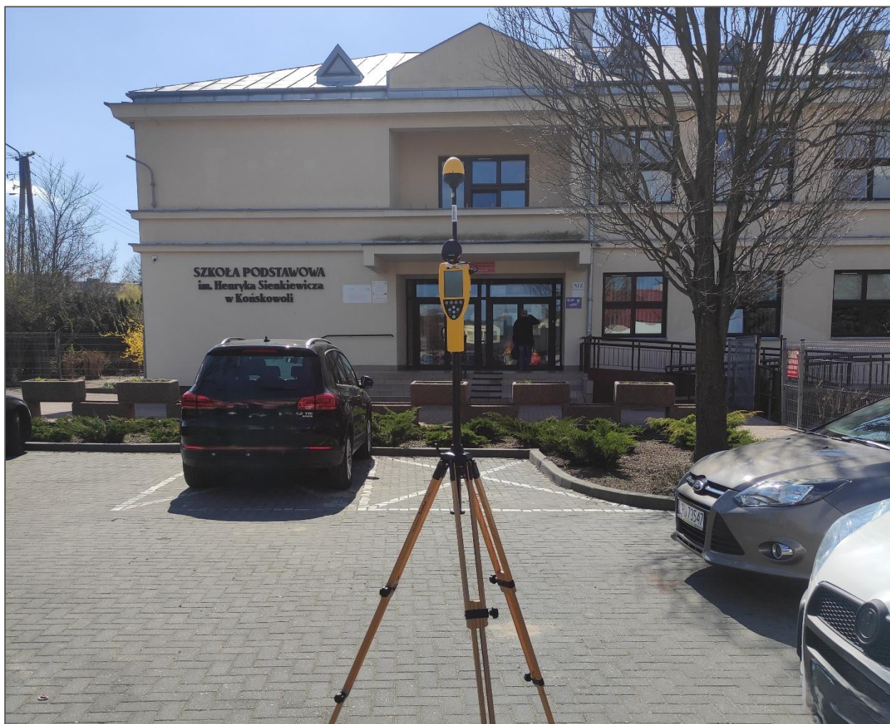
Pomiar poziomu PEM (stała sieć monitoringu pkt. w Końskowoli)
