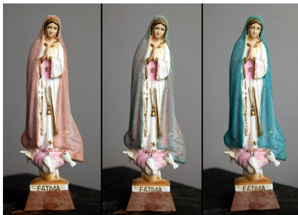
Ryc. 1. Przykład wskaźnika, w którym poziom wilgotności względnej powietrza sygnalizuje barwa chloreku kobaltu. W postaci bezwodnej ma on barwę niebieską. W wilgotnym powietrzu chlorek kobaltu przechodzi w formę dwuwodnego hydratu o barwie różowej. W miarę wzrostu wilgotności chlorek dąży do postaci sześciowodnej o barwie czerwonej. Solami kobaltu barwi się silikażel lub papierki wskaźnikowe sygnalizujące poziom wilgotności silikażelu stabilizującego klimat w kasetach i gablotach muzealnych
