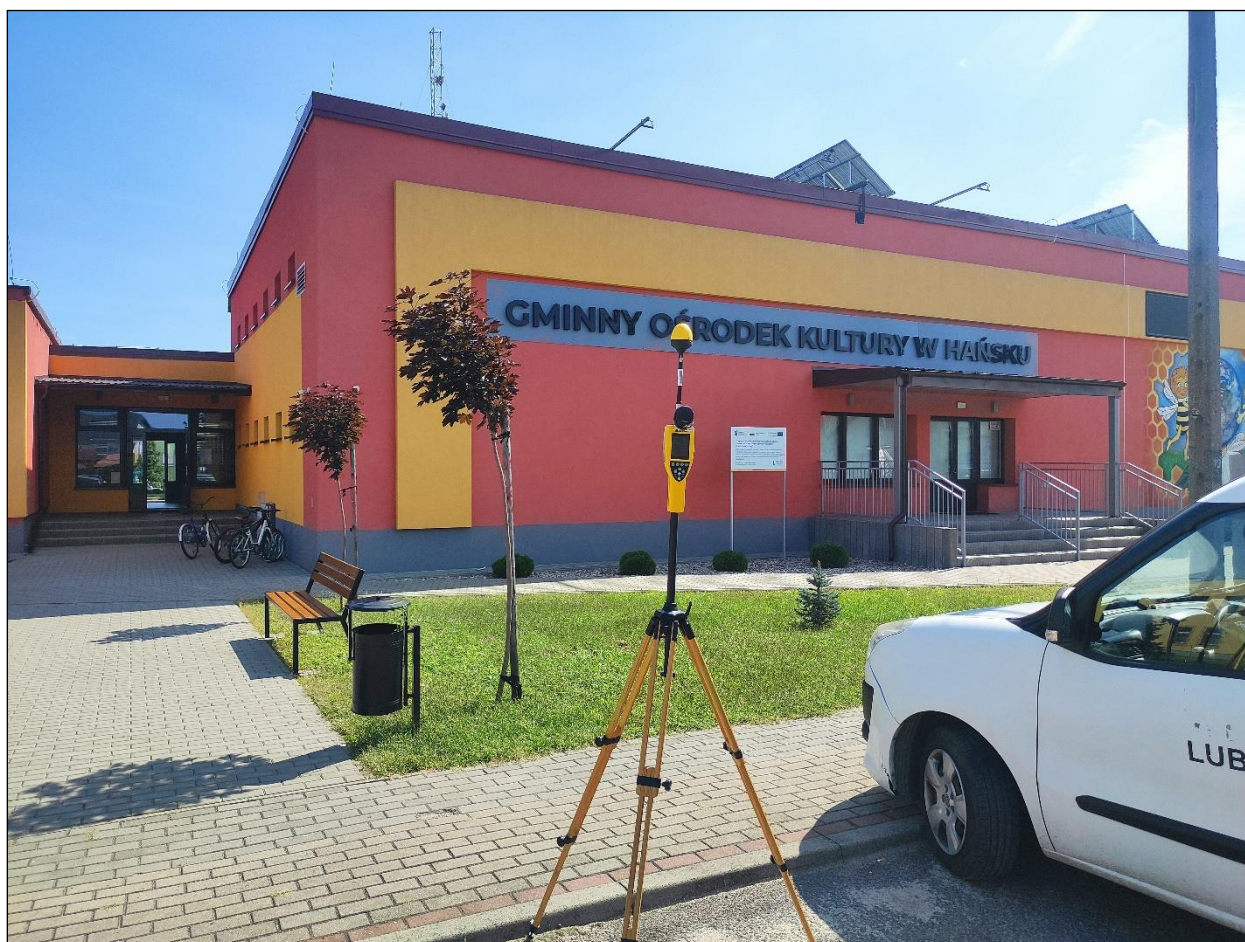
Pomiar poziomu PEM w ramach monitoringu badawczego
