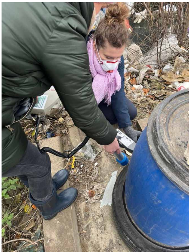
Fot. 2. Pomiar przestrzennego równoważnika mocy dawki wokół wydzielonych odpadów
