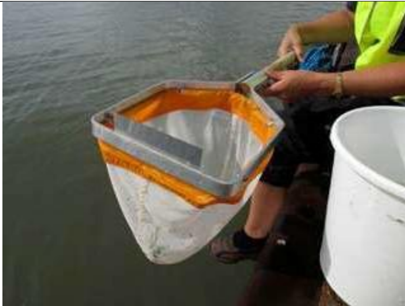
Rycina 2 Przyrząd ze skrobakiem stosowany do pobierania prób organizmów poroślowych
