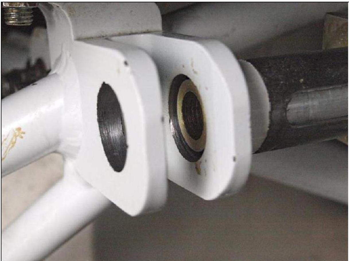
Okucie SP-TZB po naprawie, sworzeń schowany.
