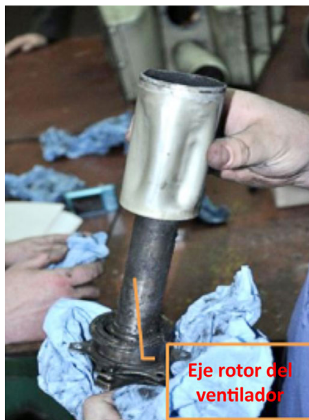
Figura 4. Deformación del casquillo exterior
