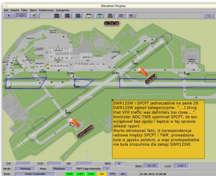
Rys.2 Zobrazowanie pozycji statków powietrznych po przyziemieniu według radaru SMR.
