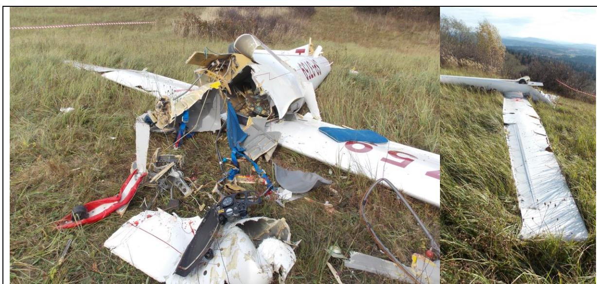
Rys.6. Zakres zniszczeń konstrukcji szybowca. [foto PKBWL]
