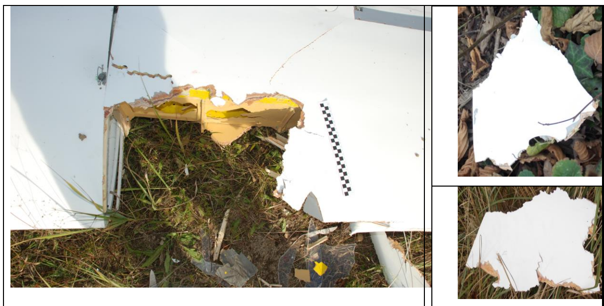
Rys.3.Obraz zniszczenia kesonu prawej końcówki skrzydła w miejscu kontaktu z drzewem. Obok, Rys. 4 i 5. Fragmenty sklejk poszycia kesonu. [foto PKBWL]
