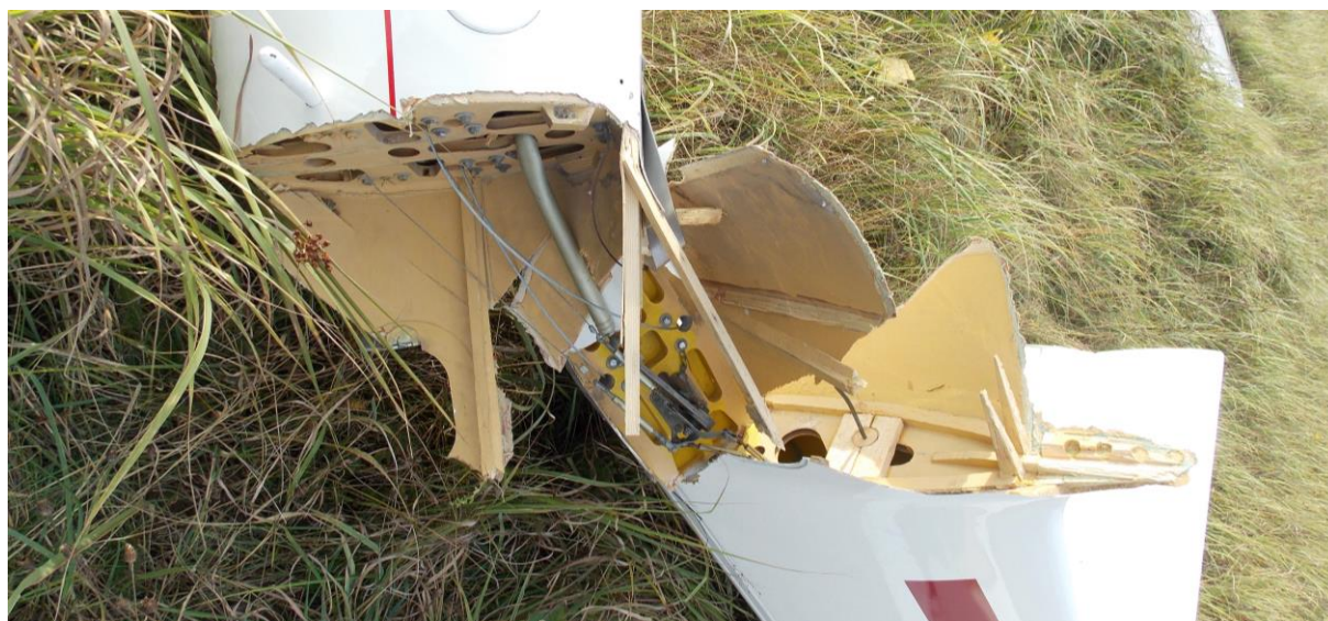
Rys.7. Oderwane od belki ogonowej usterzenie szybowca. [foto PKBWL]
