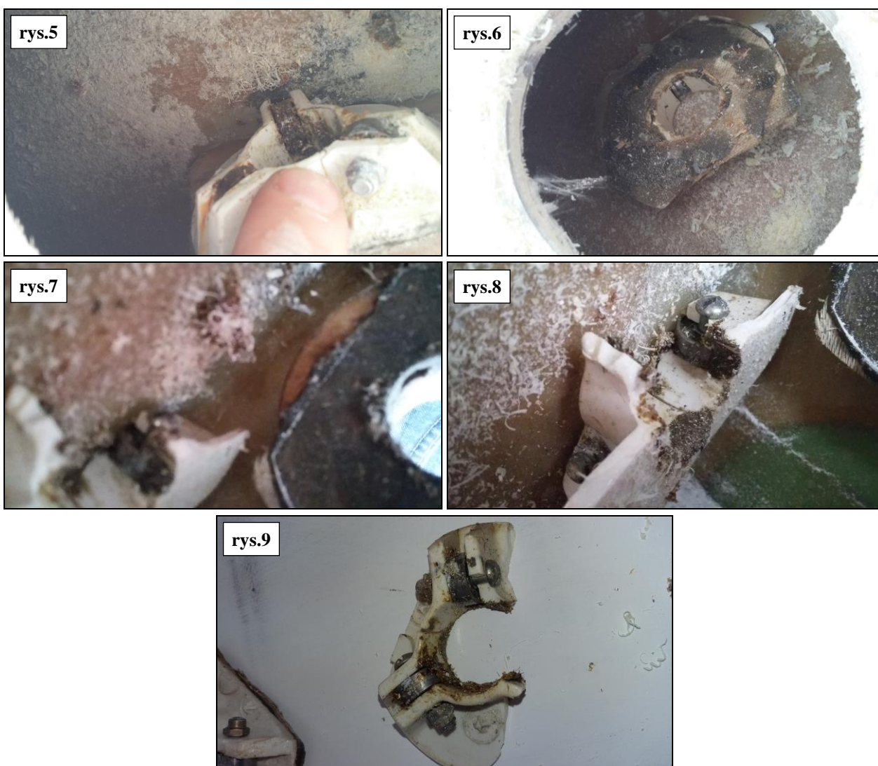
Rys.5÷9 Fragmenty uszkodzonego przepustu lotki szybowca Jantar Std 3 (inny szybowiec tego samego typu)
