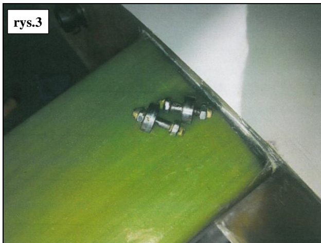
Rys.1÷4 Fragmenty uszkodzonego przepustu lotki szybowca SZD-48-3 Jantar Std 3 o znakach SP-3688 (szybowiec biorący udział w zdarzeniu)
