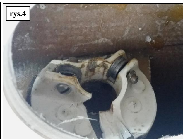
Rys.1÷4 Fragmenty uszkodzonego przepustu lotki szybowca SZD-48-3 Jantar Std 3 o znakach SP-3688 (szybowiec biorący udział w zdarzeniu)
