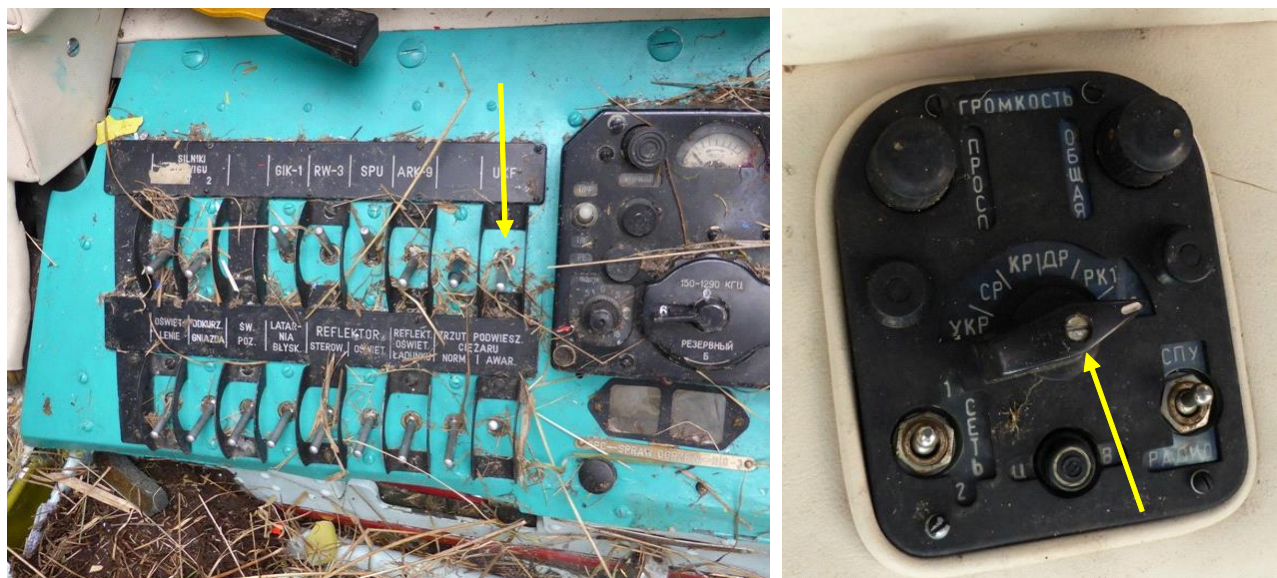
Foto 3. Widok lewego górnego pulpitu kabiny śmigłowca Mi-2 oraz pulpitu SPU
