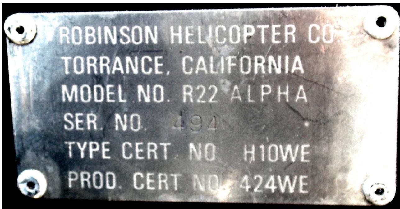
Tabliczka znamionowa na środkowej części kadłuba (w rejonie kabiny) z wyraźnym numerem fabrycznym 494.
