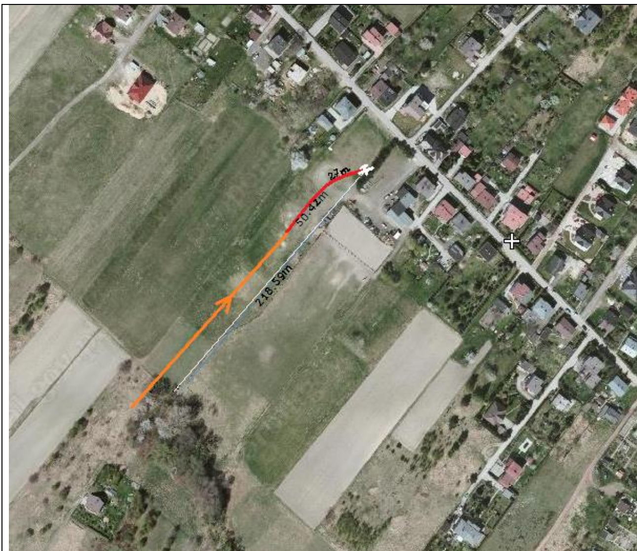
Rys. nr 1 Kierunek podejścia do lądowania awaryjnego, przebieg dobiegu i sposób zatrzymania się samolotu ZLIN SAVAGE.
