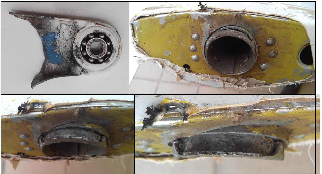
Oderwana konsola lotki i resztki jej spoiny na tylnym dźwigarku skrzydła.
