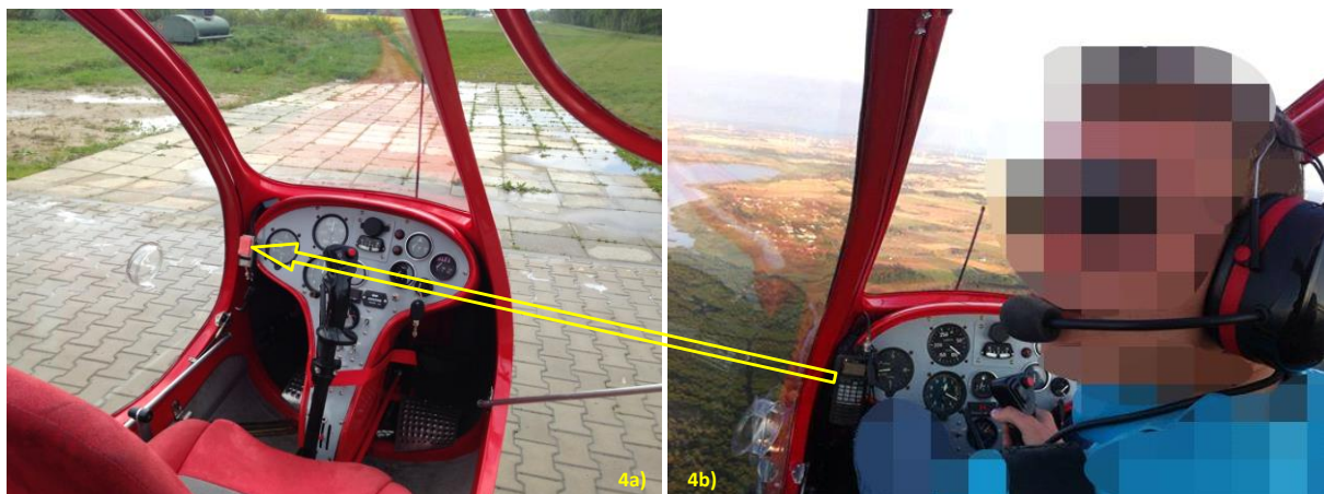
Rys. 4. Wiatrakowiec Twister A21MMS – tablica przyrządów [zdjęcia: 4a) W. Jarzyna, 4b) forum.lotniczapolska.pl]
