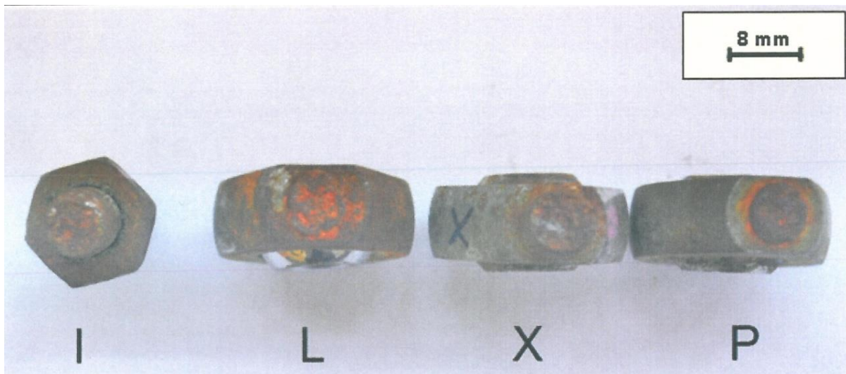
Rys. 10. Widok przelomów zniszczonych elementów poddanych badaniu
