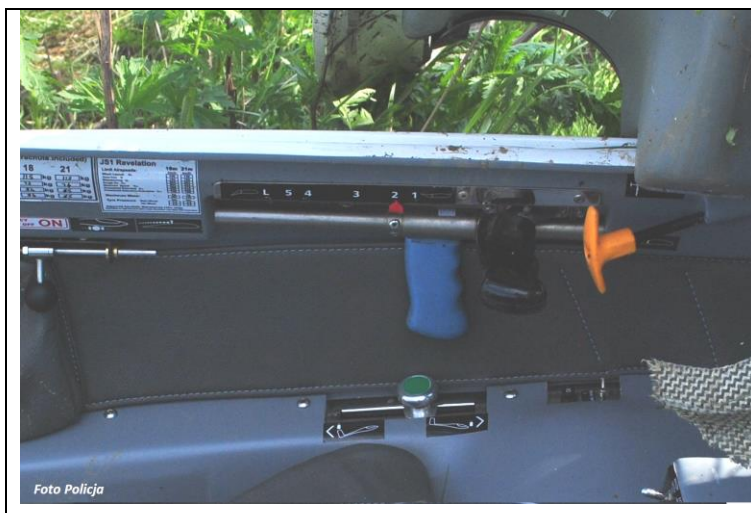
Ilustracja nr 8. Położenie dźwigni klap po wypadku. Widoczne prawidłowe ustawienie dźwigni trymera
