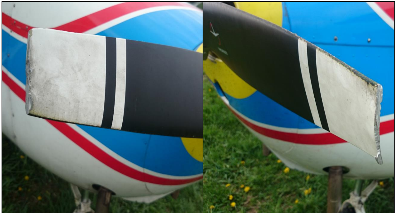
Rys.5 i 6. Zdjęcia obrazujące uszkodzone końcówki obu łopat śmigła.
